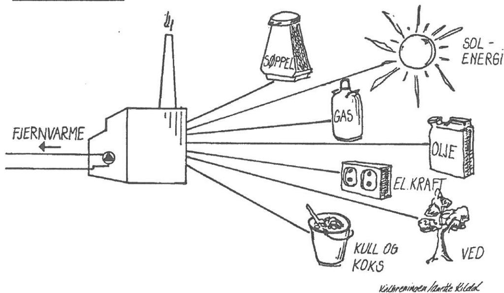
Sentralen produserer varmt vann med høy temperatur og høyt trykk ved bruk av oljekjeler, elektrokjeler, avfallskjeler eller andre former for varmekilder. Med avfallskjeler kan man utnytte energi som ellers ville gå tapt. Når man i samme sentral har flere varmekilder kan man til enhver tid benytte den energiform som er tilgjengelig og billigst.
